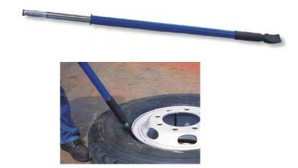
使用TO-A 如上圖可胎緣與鋼圈產生較大間隙,便於其他拆胎動作。
